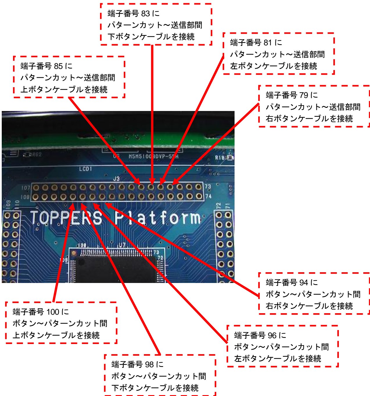
図 13.8-1 TOPPERS Platform ボードコネクタ取り付け（ボタン・送信部ケーブル用）
